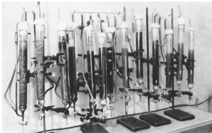
Abb. 2. Vier Perkolatoren-Batterien vor Inbetriebnahme
